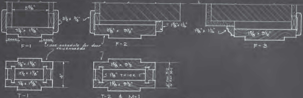
*DOOR FRAME DETAILS.* SCALE: 3" = 1'-0"
